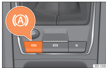
Afb. 152 Onder in de middenconsole: functietoets Auto Hold.
