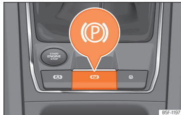
Afb. 151 Onder in de middenconsole: toets van de elektronische parkeerrem.
