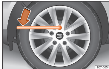
Afb. 246 Wiel verwisselen: wielbouten losdraaien.
