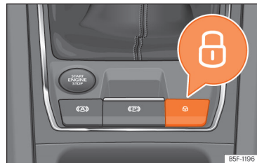
Afb. 76 In de middenconsole: knop voor centrale vergrendeling
