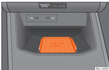
Afb. 136 In de middenconsole: steun voor het aansluiten van de mobiele telefoon.
