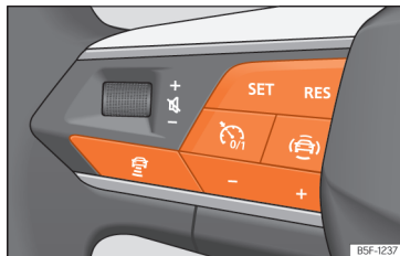
Afb. 104 Op het multifunctiestuurwiel: knoppen voor bediening van ACC.
