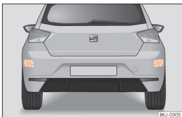
Afb. 97 Achteraanzicht van de wagen: zones van de radarsensoren.
