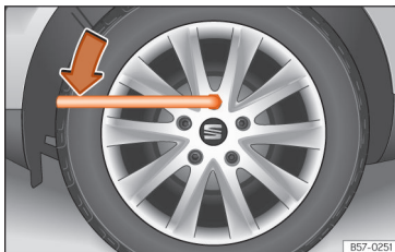
Afb. 189 Wiel verwisselen: wielbouten losdraaien.
