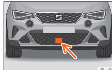
Afb. 92 In de voorbumper: radarsensor.
