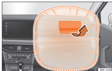
Afb. 26 Bijrijdersairbag in het dashboard.
