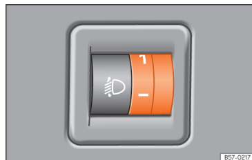
Afb. 70 Naast het stuur: lichtbundelhoogteverstelling.
