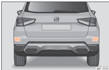
Afb. 95 Achteraanzicht van de wagen: zones van de radarsensoren.
