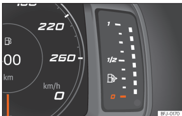
Afb. 4 Instrumentenpaneel SEAT Digital Cockpit: brandstofmeter.
