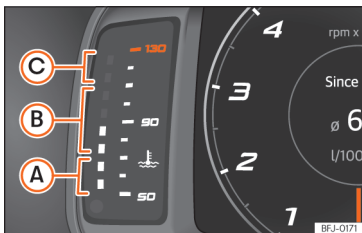
Afb. 6 Digitaal instrumentenpaneel SEAT Digital Cockpit: koelvloeistoftemperatuurmeter.
