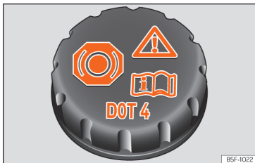
Afb. 182 Motorruimte: dop van het remvloeistofreservoir.
