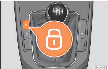
Afb. 50 Middenconsole: knop voor centrale vergrendeling.
