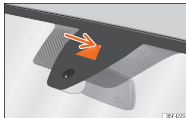
Afb. 94 Op de voorruit: gezichtsveld van de rijstrookassistent.
