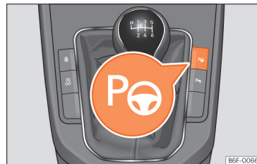
Afb. 123 In de middenconsole: toets om het inparkeersysteem in te schakelen.
