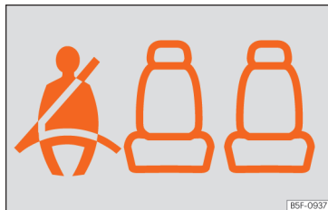
Afb. 18 Instrumentenpaneel: indicatie van de staat van de veiligheidsgordels voor de zitplaatsen achterin.
