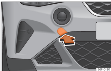
Afb. 164 Aan de rechterzijde van de voorbumper: de afdekking verwijderen.
