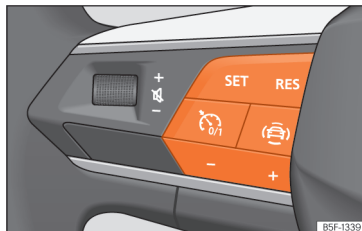
Afb. 133 Op het multifunctiestuurwiel: knoppen voor bediening van de snelheidsbegrenzer.
