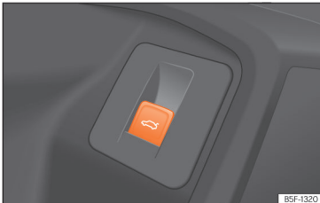
Afb. 82 In het bestuurdersportier: knop om achterklep te openen en sluiten.
