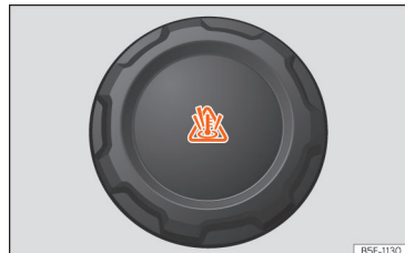
Afb. 228 Voorruimte: vuldop van het koelvloeistofexpansiereservoir.
