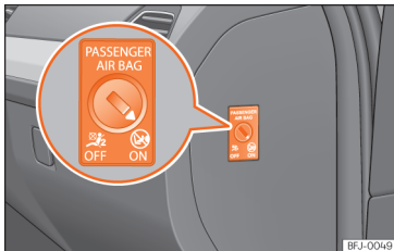
Afb. 31 Sleutelschakelaar voor het in- en uitschakelen van de bijrijdersairbag.
