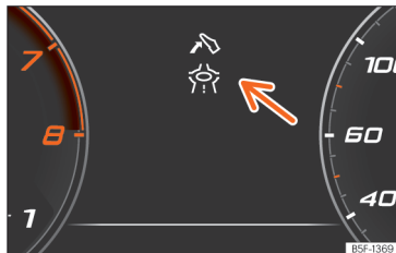
Afb. 134 Aanwijzing van het hulpsysteem voor eco-efficiënt rijden (schematische voorstelling).
