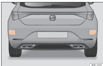
Afb. 129 Achteraanzicht van de wagen: zones van de radarsensoren.
