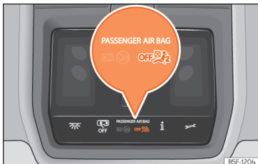
Afb. 32 In de dakconsole: controlelampje van uitschakeling bijrijdersairbag.
