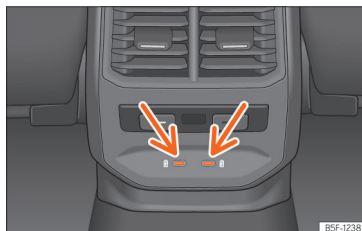
Afb. 172 Achterzijde middenconsole: USB-aansluitingen met functie van stroomvoorziening.
