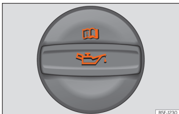
Afb. 234 In de motorruimte: dop van de motorolie-vulopening.
