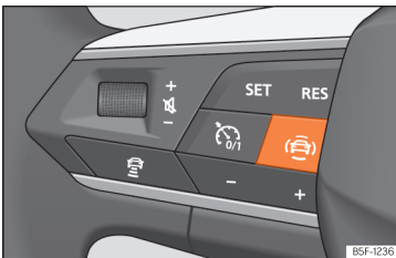
Afb. 125 Linkerzijde van het multifunctiestuurwiel: toets voor de bestuurdershulpsystemen (naargelang het model).
