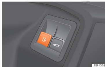
Afb. 209 Bestuurdersportier: ontgrendeling van de tankklep.
