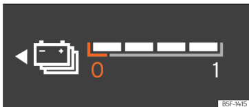
Afb. 8 Digitaal instrumentenpaneel: accupeilmeter.
