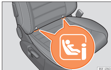
Afb. 44 Bijrijdersstoel: locatie van de i-Size-bevestigingsbeugels.
