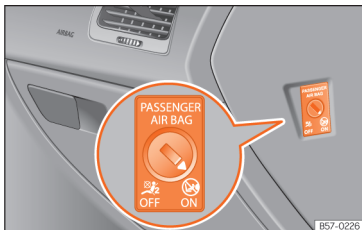
Afb. 29 Sleutelschakelaar voor het in- en uitschakelen van de bijrijdersairbag.
