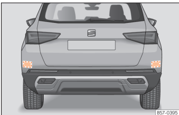
Afb. 111 Achteraanzicht van de wagen: zones van de radarsensoren.
